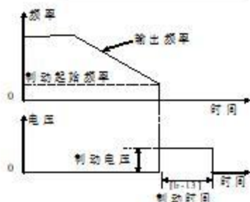
图 5-15 停机时的直流制
